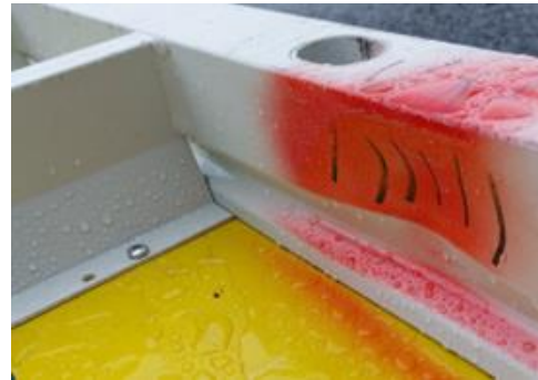
Iskrivljenje uzdužnog profila okvira
