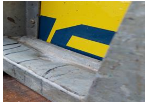
Deformacija elementa – nije moguće spajanje pomoću stezača
