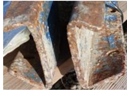
Uvrnuto i deformirano > 5mm
