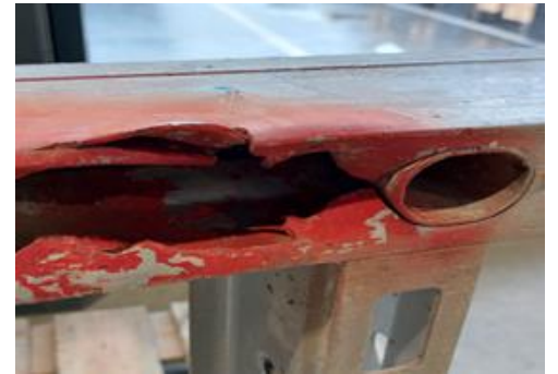
Puknut uzdužni profil okvira
