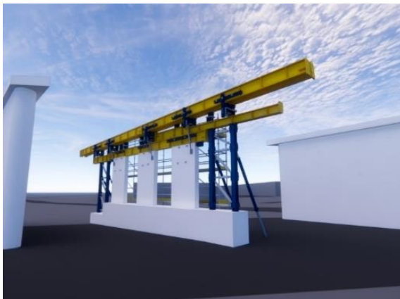
Aufrüsten des Mittelpfeilers – digital und real. © Doka/Swietelsky
