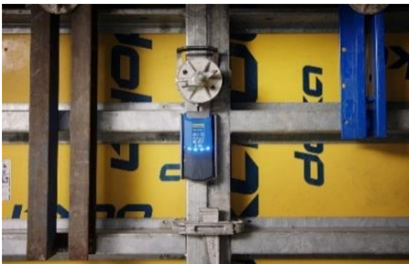
Der DokaXact Load-Sensor dient zur präzisen Überwachung der Ankerlast in Echtzeit. © Doka
