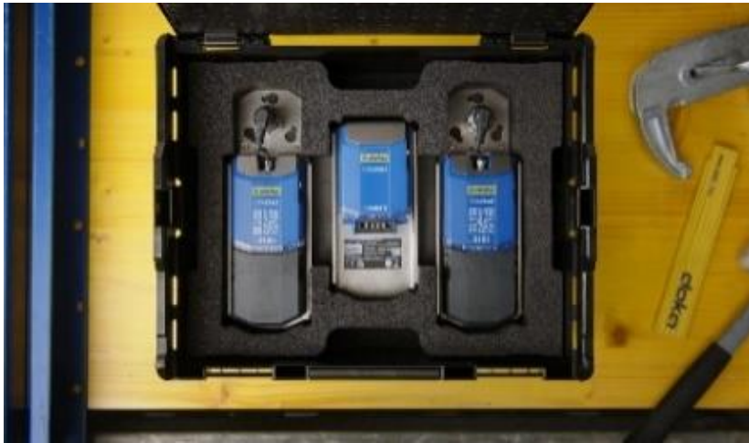
Der DokaXact Pressure-Sensor übermittelt Live-Daten zur Überwachung des Frischbetondrucks. © Doka
