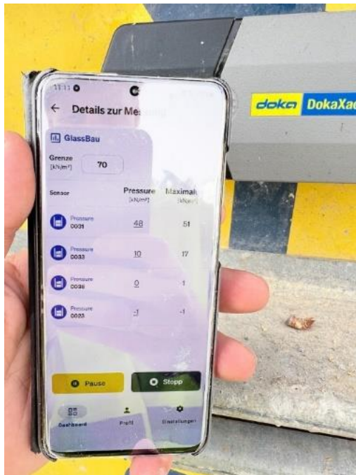
Per DokaXact Pressure ermittelte die Glass GmbH Bauunternehmung die optimale Betoniergeschwindigkeit, die deutlich höher lag als vorab konventionell per Berechnungstabelle kalkuliert. (Hardware hier als Testversion). © Doka
