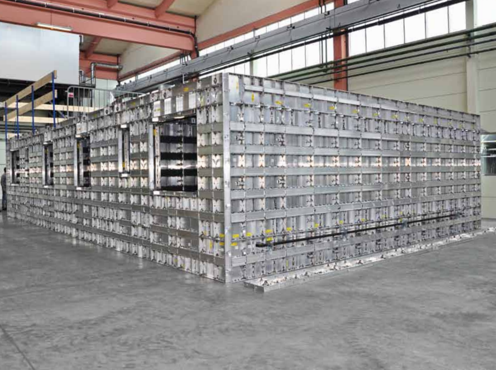
▲ 使用 Doka OneGo，墙壁和楼板可以一步浇注
