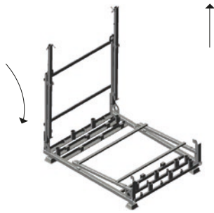
(4) Soulever légèrement les deux traverses avant le pliage
