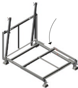
(4) Rabattre le cadre sans traverses vers l'intérieur du rack
