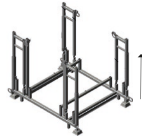
(3) Soulever le tube qui bloque le poteau d'angle sans traverse horizontale
