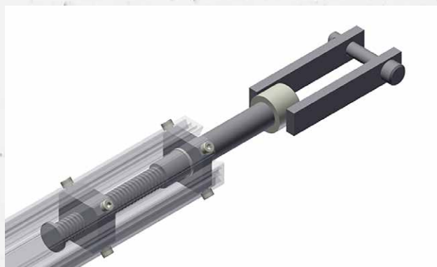
Le filetage est protégé de l'écrasement grâce au recouvrement du bracon et permet une longue durée de vie ainsi qu'une maintenance minimale.
