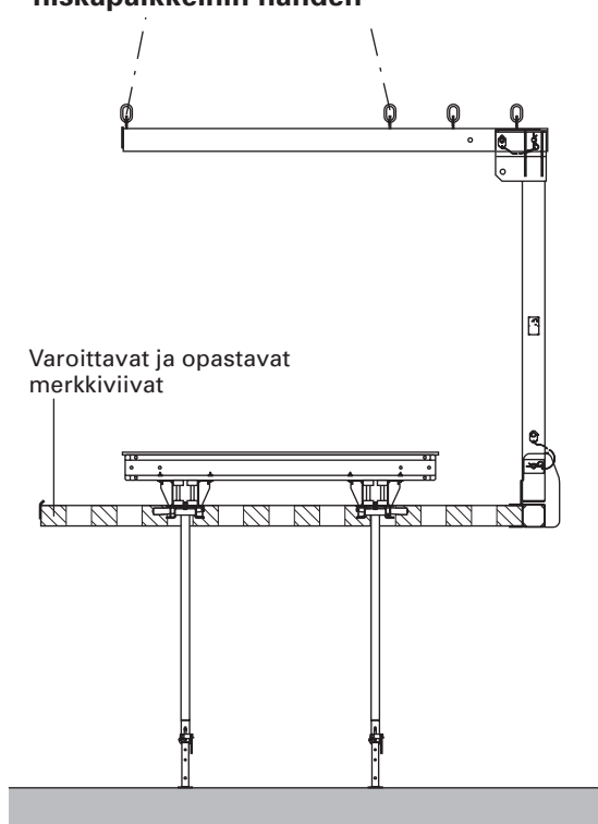
Esimerkki haarukan sijoituksesta pokittain niskapalkkeihin nähden
