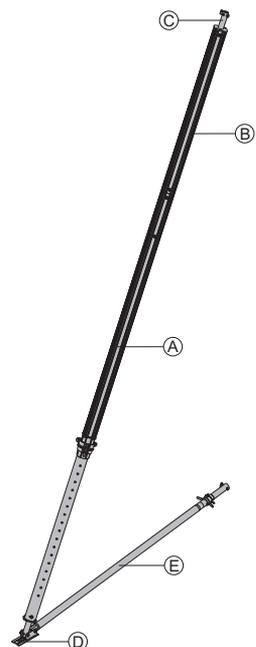
**Головка стойки RD EB**
