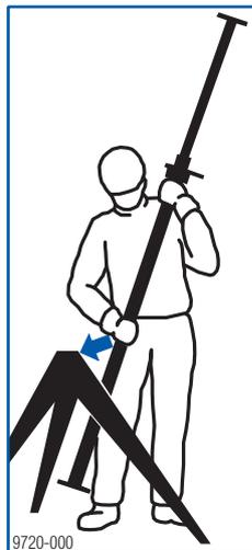
► Realizar un ajuste preciso mediante la tuerca de ajuste de los puntales que están de pie.
