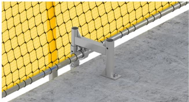
**Paso 16:** Mientras las redes estén aún conectadas a la grúa plegadas, perfore en la fijación para losa un agujero prefijado con la profundidad necesaria y fije 2 pernos de anclaje M12, uno para cada fijación para losas, y apriételos para asegurar una fijación del anclaje correcta a la losa.
