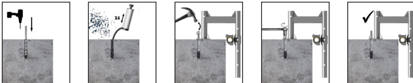
1. Perforar un taladro y limpiar el polvo de la perforación y de escombros (utilizando una bomba de soplado o un método similar)
