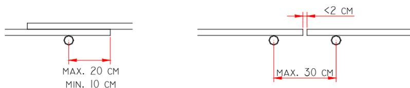
**Ilustración 6.5:** Disposición de los tablones de madera
