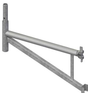
La ménsula se puede utilizar para ampliar la plataforma de trabajo. Esta expansión se puede llevar a cabo mediante una ménsula con una sola plataforma (ménsula de 0,39 m de ancho) o por una ménsula de dos plataformas (ménsula de 0,73 m de ancho)
