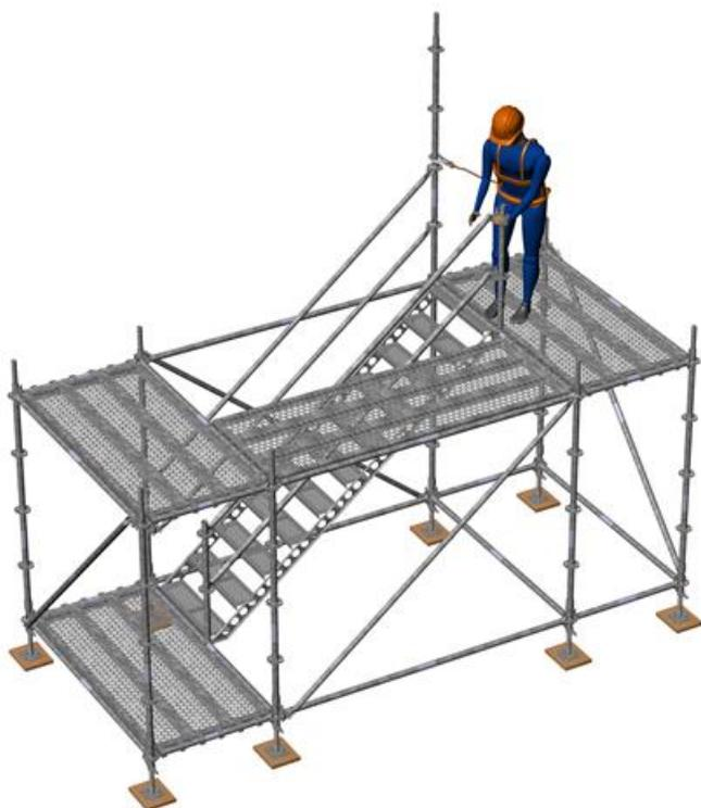
6. Para colocar los verticales del siguiente tramo, es necesario colocar las plataformas de acero (temporalmente de forma parcial). Coloque los montantes para la barandilla y añada las diagonales. Antes de montar el resto del siguiente tramo, es necesario conectar el arnés de seguridad (para elevaciones inferiores usar una línea más corta) a una posición como se describe en el capítulo 9.5. Nota: Para trabajar en el primer tramo, es necesario utilizar una arnés de seguridad con una línea corta.
