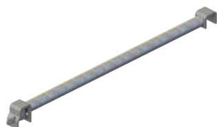
La traverse intermédiaire réduit les espaces vides des segments d'échafaudage pouvant être recouverts d'une planche en bois. La position de la traverse est fixée avec une cale.
