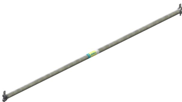
Le longeron est un tube de 48,3 mm de diamètre pourvu d'une cale conique aux deux extrémités. Le longeron est utilisé dans différentes longueurs pour soutenir les planches en acier ou en bois ou en tant qu'élément de la structure. Le longeron est également utilisé en tant que garde-corps ou rail de protection latérale.
