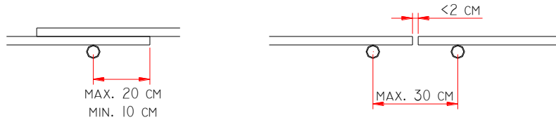
Abbildung 6.5: Anordnung der Holzbohlen
