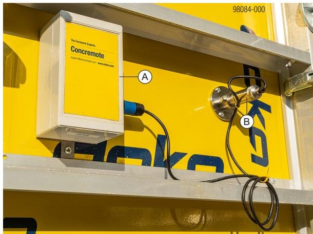
**A** Capteur à câble Concremote 2.0
