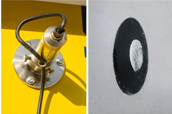
Le capteur à câble avec un câble de mesure (jusqu'à 3 points de mesure) permet de mesurer la température centrale.
