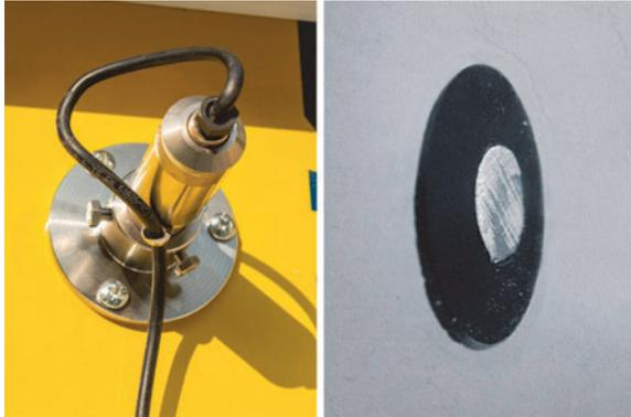
Zur Messung der Kerntemperatur ist der Kabelsensor mit einem Messkabel (bis zu 3 Messpunkte) geeignet.
