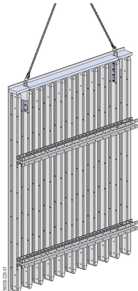
Les câbles de la grue sont fixés aux crochets de levage pour translater les banches. Celle-ci est boulonnée à l'âme des poutrelles Doka.
