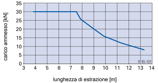
\* trazione 15 kN a ogni lunghezza di estrazione
