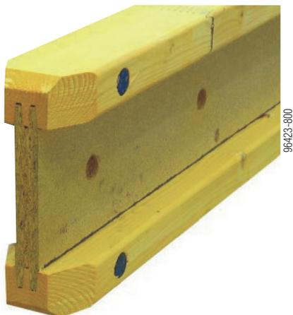
Der Holzschalungsträger H20 eco ist ein Vollwandträger gemäß EN 13377 mit bewährter Endverstärkung durch Abschrägung der Trägerenden und zusätzlichem Kunststoffniet im Trägergurt.
