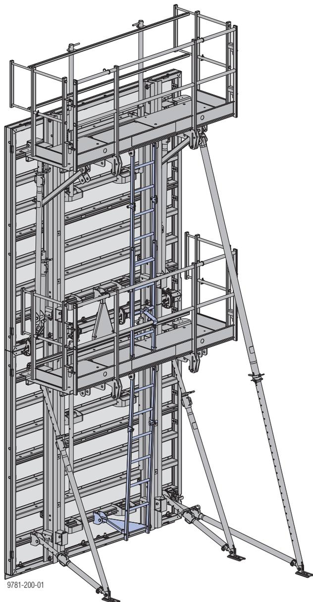
Pour un accès d'échelle entre deux passerelles il convient de **rallonger l'échelle** et de **la fixer au garde-corps arrière**.
