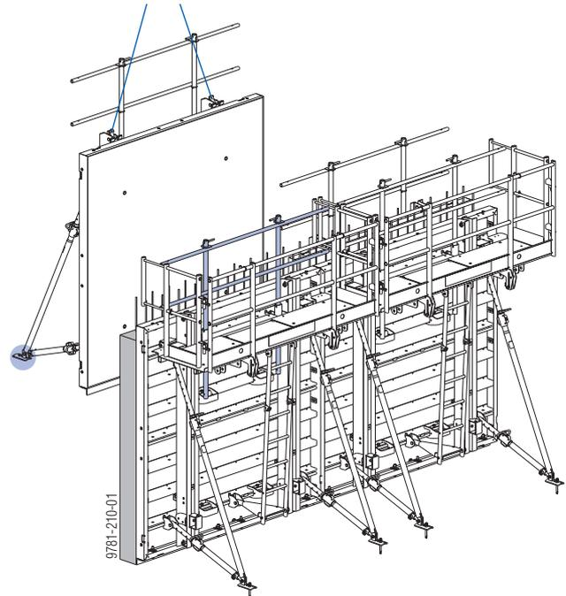
Si la banche est destinée à être stockée provisoirement, veiller à ce qu'elle soit suffisamment stable (voir le chapitre « Béquilles de réglage »). Ne stocker provisoirement les banches que lorsqu'elles sont pourvues d'un étaçon de banche.
