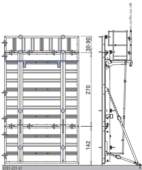
② Pour une hauteur de coffrage de 442 cm il n'est pas nécessaire d'utiliser des ancrages en rive supérieure du coffrage.
