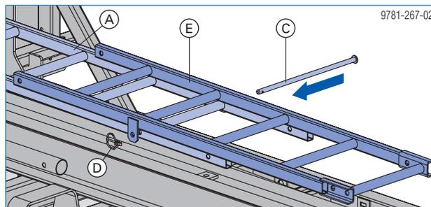
➤ Fixer l'échelle avec la rallonge à l'aide du support d'échelle SC plus au garde-corps arrière.
