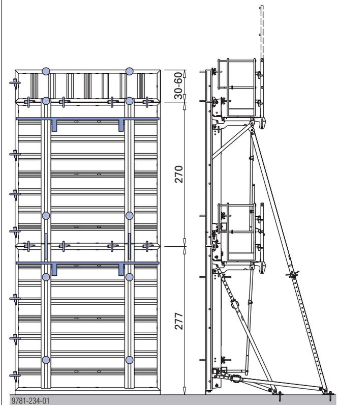
③ Pour une hauteur de coffrage de 577 cm il n'est pas nécessaire d'utiliser des ancrages en rive supérieure du coffrage.
