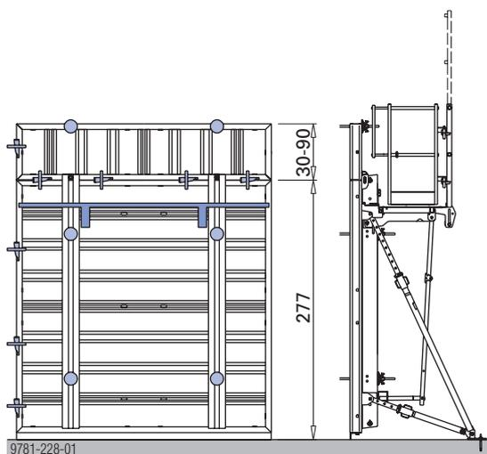
① Pour une hauteur de coffrage de 307 cm il n'est pas nécessaire d'utiliser des ancrages en rive supérieure du coffrage.
