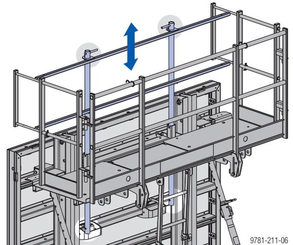
Si l'on n'a pas besoin du garde-corps face coffrante, il suffit de le rabattre.
