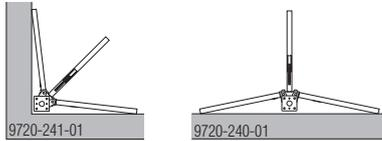
Lorsque les trépieds amovibles ne peuvent pas se déplier complètement, par ex. le long des voiles, au niveau d'une rupture de dalle, etc. nous recommandons de fixer le trépied amovible sur un autre étau, où il pourra être complètement déplié.
