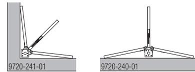
Können Stützbeine an Gebäudekanten, Deckendurchbrüchen etc. nicht komplett aufgeklappt werden, empfehlen wir, das Stützbein an einer anderen Deckenstütze zu befestigen, an der ein volles Aufklappen der Beine möglich ist.
