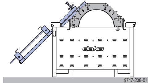
▶ Anschluss XS RS im Vertikalprofil des Stützelementes RS einfädeln und in oberer Bohrung mit Bolzen und Klappstecker sichern.
