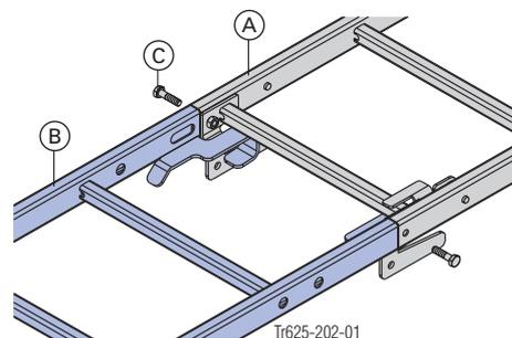
Schrauben (C) im Lieferumfang der Systemleiter XS 4,40m und der Leiterverlängerung XS 2,30m enthalten.
