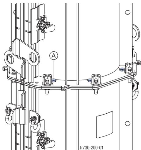
Zur Montage der Schrauben sind die Bohrungen  $\varnothing 20$  mm an den Außenspannen zu verwenden
