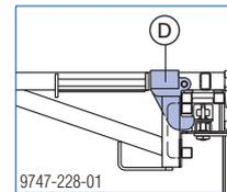
Sicherungshaken (D) fällt nach unten in Ausgangsstellung und sichert dabei die Bühne automatisch gegen unbeabsichtigtes Ausheben.
