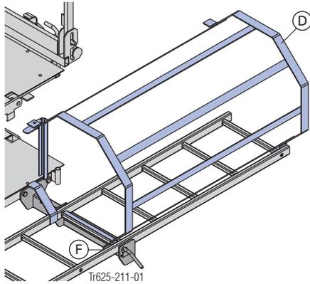
**D** Rückenschutz-Ausstieg XS**F** Sicherungsklinke (Aushebesicherung)
