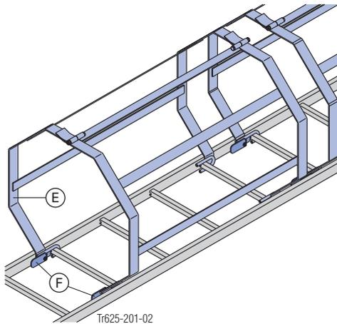
**E** Rückenschutz XS**F** Sicherungsklinken (Aushebesicherung)**Einschalen**
