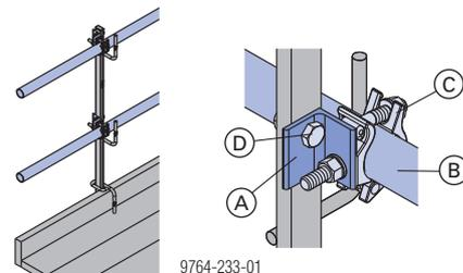
Werkzeug: Gabelschlüssel 22 zur Montage der Kupplungen und Gerüstrohre.
