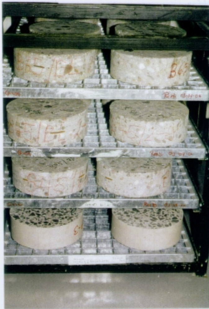
Bild 9: Lagerung der Proben für die Prüfung der Gasdurchlässigkeit bei 20 °C und 65 % rel. Luftfeuchte vom 70. (1. Prüfserie) bis zum 210. Tag (2. Prüfserie).
