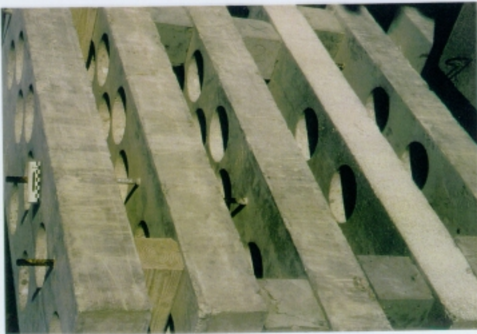
Bild 5: Modellwände mit Bohrkernentnahmestellen
