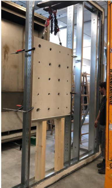
Bild 8: Einbau des Betonblockes (Seite 1)
