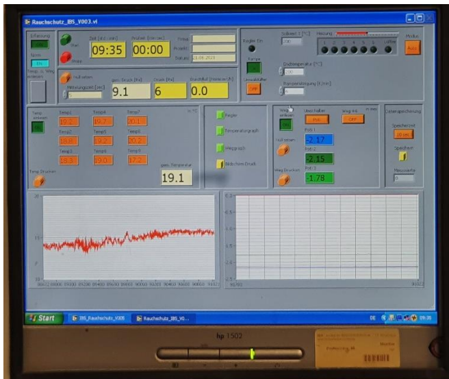
Bild 14: Messanzeige bei 6 Pascal Druck => 0 Druckverlust = kein Luftaustritt bei den Span
