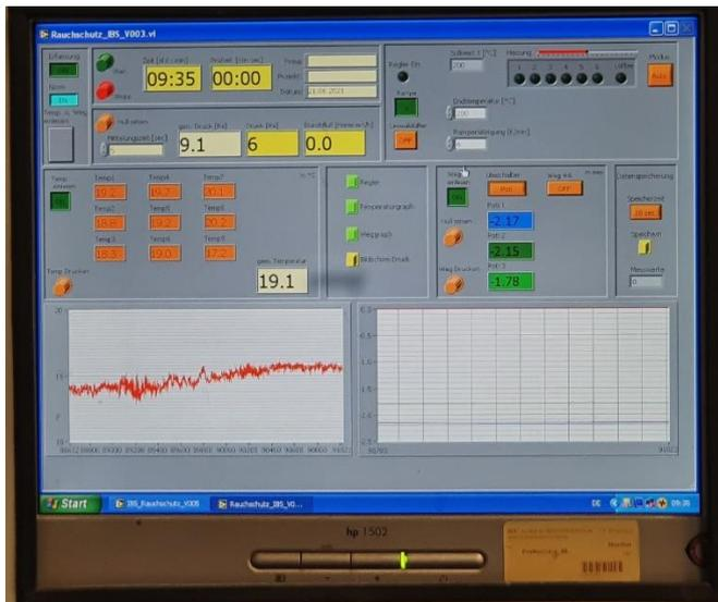
Bild 14: Messanzeige bei 6 Pascal Druck => 0 Druckverlust = kein Luftaustritt bei den Span
