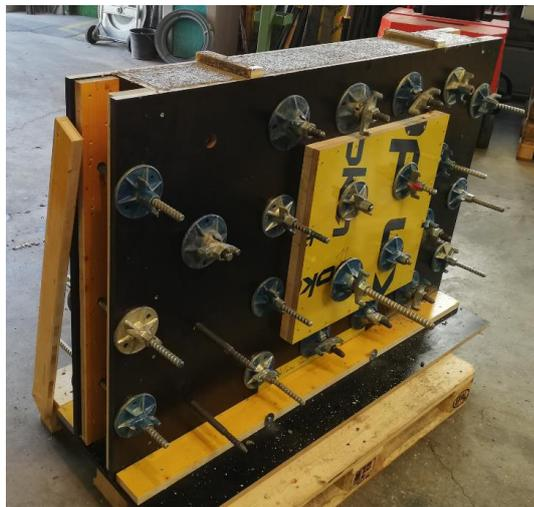
Bild 5: fertig betonierter Versuchskörper
