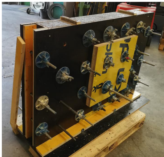
Bild 5: fertig betonierter Versuchskörper
