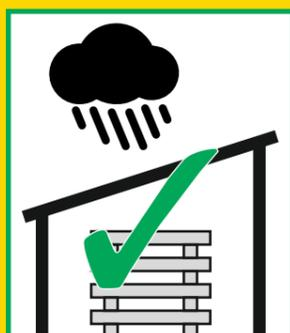
**Stocker les panneaux pour béton architectural à l'abri des intempéries !**
