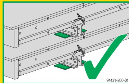
**Protéger la peau coffrante des dégâts lors du gerbage des panneaux !**
