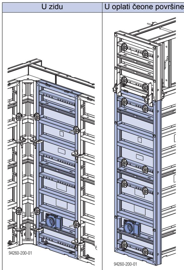
**A** Priključak za crijevo pumpe s kliznim zatvaračem D125 SCC
