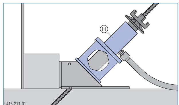
**H** cilindar z votlim batom in tlačnim podstavkom
