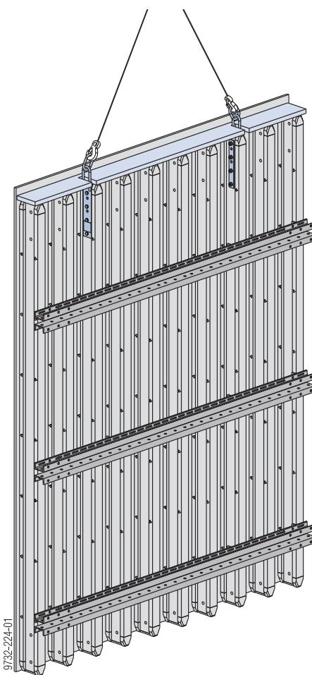
Sajle krana za podizanje elemenata se pričvršćuju za kuke za kran. Vijcima se pričvršćuju za rebra Doka nosača.
