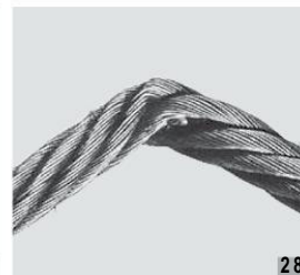
Durch mechanische Einwirkung entstandener Knick
