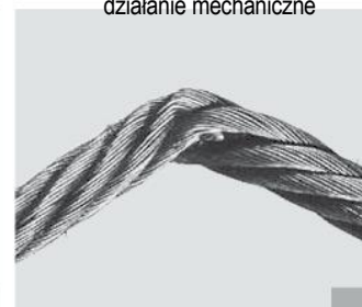
Zgięcie powstałe przez działanie mechaniczne
