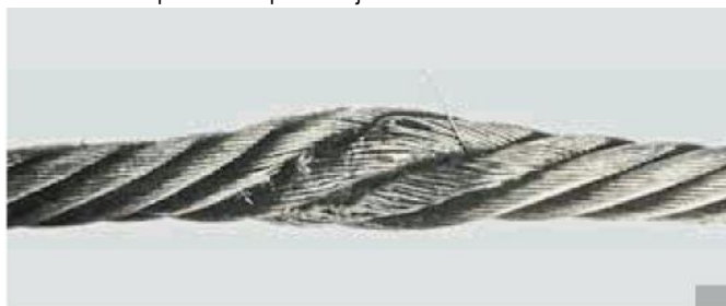
Lina stalowa spłaszczona przez rozjechanie
