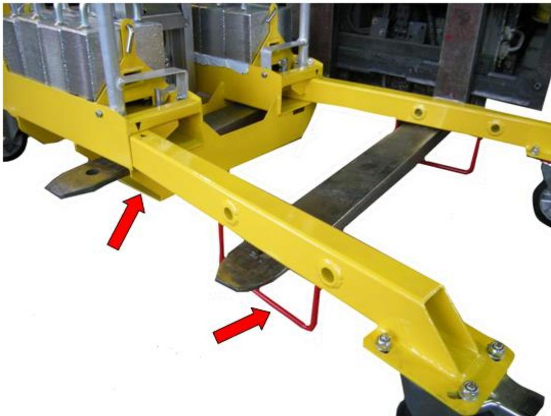
Abb. 38 Aufnahmen zum Staplertransport
