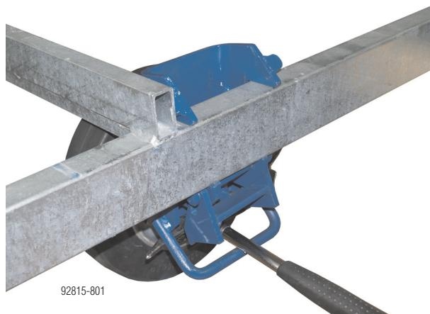
► Montați ambele rotile de încărcări grele aliniat, lipit de bara de legătură.
