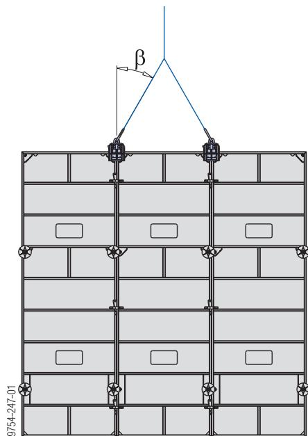
Force portante max. : 500 kg / crochet de levage
